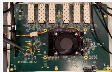
El bloque de procesamiento de datos (DPB3) diseñado por la UPV cumple con los requisitos técnicos establecidos. Se ha completado el diseño final, que mejora tanto la fiabilidad como la durabilidad. Las mejoras se han logrado asegurando que tanto la PCB como el ensamblado cumplan con el estándar IPC Clase 3.
