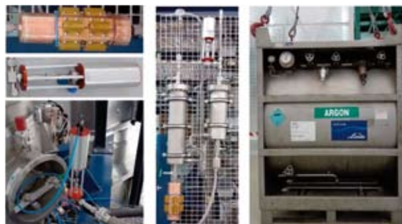
Figura 6.2: Evaporador y válvulas motorizadas (izquierda), componentes del filtro (medio) y tanque de LAr (derecha), utilizados para el llenado de casi 1.5 toneladas de LAr del target de ArDM
