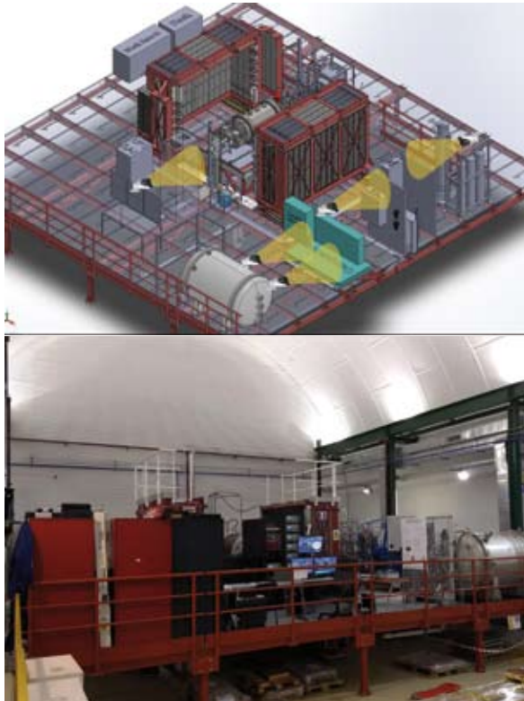
Figura 7.1: Panel superior: diagrama que muestra el detector NEW y las infraestructuras asociadas en el LSC (los haces de luz amarillos marcan la cobertura de las webcams para el control remoto de los parámetros del experimento). Panel inferior: imagen real del equipamiento en el LSC.
