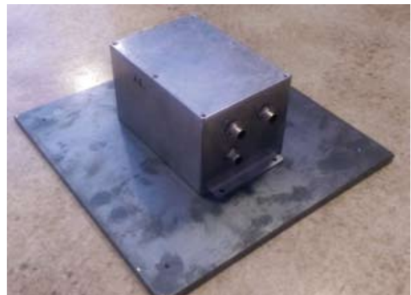
Fig.13.1: El sensor sísmico montado sobre una placa de acero. Los dos conectores superiores son utilizados para la comunicación de datos, mientras que el inferior se utiliza para el suministro de potencia.
