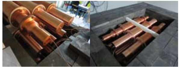
Fig. 5.5. Vista de la disposición de los módulos de NaI(Tl) durante el montaje de ANAIS112 en el LSC en marzo de 2017.
