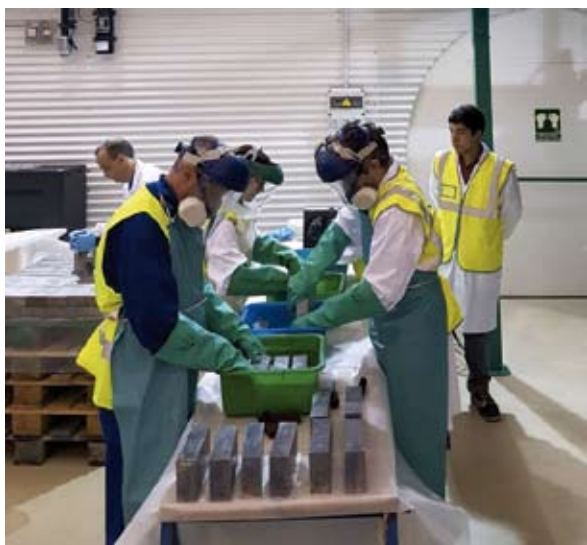
Fig. 2.1: Limpieza de plomo en preparación de la instalación de TREX-DM en el Hall A
