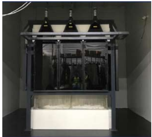
Fig. 5.6. Montaje de ANAIS112 antes de completar la instalación del blindaje de neutrones. Se pueden observar los detectores de centelleo plásticos instalados en mayo de 2017.
