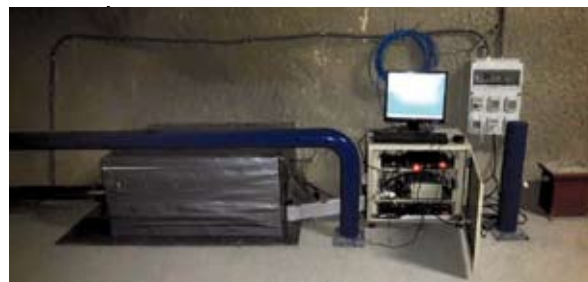
Figura 10.6: Nueva configuración del soporte principal del interferómetro GAL16
