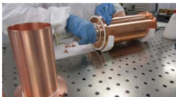
Fig. 5.2. Acoplamiento de los PMTs a los módulos D6, D7 y D8 en la sala blanca del LSC en marzo de 2017.
