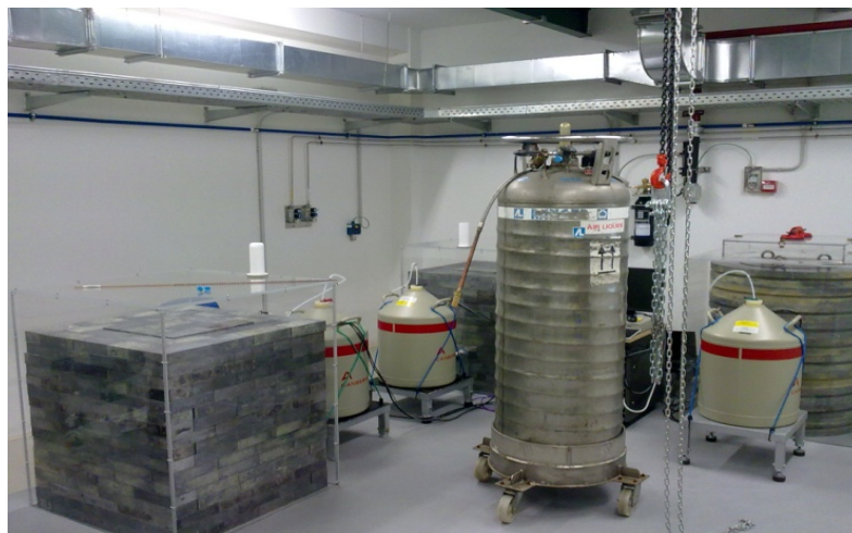
Detectores Ge hiperpuros, dentro de sus blindajes de Pb y Cu
