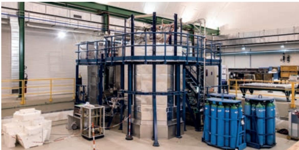
Fig. 5.1 Se completó la construcción del equipo ArDM para la primera fase del experimento en el Hall A del LSC. El blindaje de neutrones fabricado en polietileno (blanco, en el centro) fue construido en su totalidad para albergar la vasija del detector. La mitad inferior fué cubierta con paneles de aluminio contra incendio (por fuera) y aislantes térmicos (por dentro).
