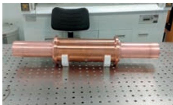
Fig. 2.2 Esta foto muestra en encapsulado de cobre de uno de los cristales NaI (TI) junto a dos fotomultiplicadores (PMT) a ambos lados. El encapsulado de los PTMs está fabricado con cobre electro-formado
