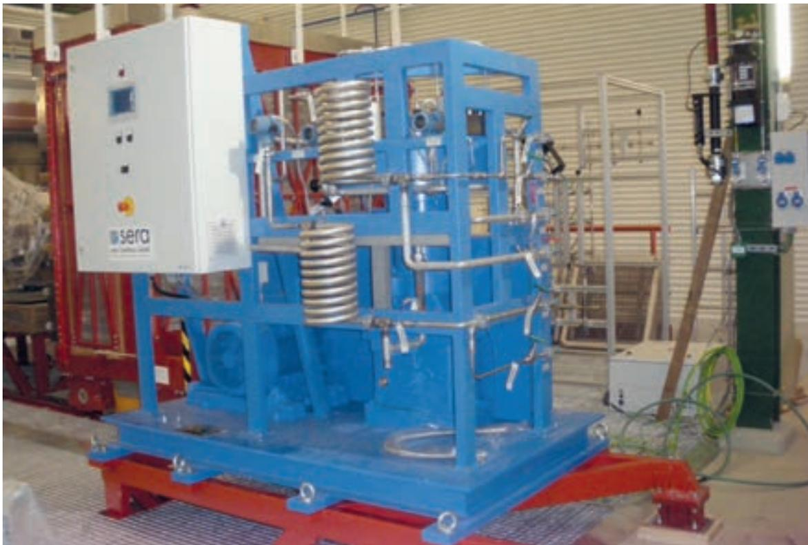
Fig. 6.2: El compresor escogido por NEXT ha sido manufacturado por la compañía alemana SERA. Se caracteriza por disponer de triple diafragma y sellos metal-metal. Entre cada par de diafragmas hay instalado un sensor cuya función es detectar posibles fugas. En caso de que se detecte una fuga, el compresor puede apagarse automáticamente.
